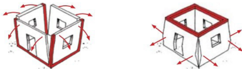
Figura 3. Muret e një ndërtese të thjeshtë nuk pengohen mos të bien vetëm nga prania e kolonave. Brezat në nivelin e çatisë ose trarët lidhës mund ta lidhin ndërtesën së bashku. (Nga libri udhëzues për ndërtimin e shtëpive rezistente ndaj tërmetejeve në muraturë të mbyllur (Enciklopedia Botërore e Strehimit, 2018).
