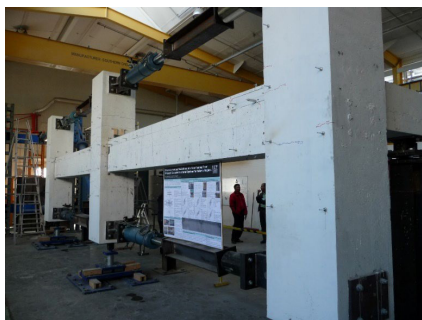
Figura 1. Kolonat dhe trarët prej betoni të armuar në shkallë të reale që testohen në laborator.
