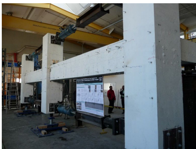
Figura 1. Kolonat dhe trarët prej betoni të armuar në shkallë të reale që testohen në laborator.
