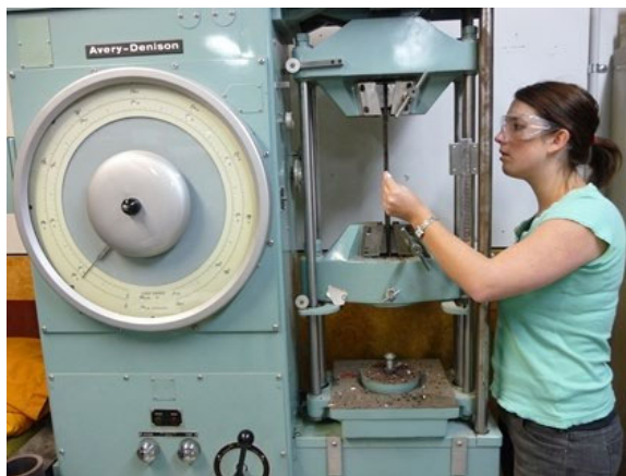
Figura 1. Një shufër përforcuese po testohet për të kontrolluar se është në përputhje me standardin.
