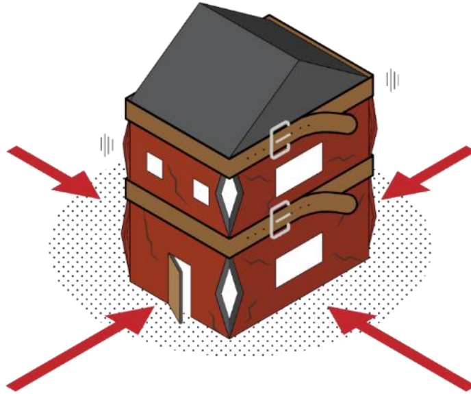
तस्वीर 1. भूकंप के दौरान एक क्षतिग्रस्त मकान को टाई बीम के माध्यम से जोड़ के रखा जा सकता है, जो कि मजबूत पट्टी (belt) की तरह काम करती हैं।
