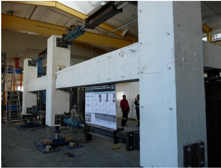
तस्वीर 1. एक प्रयोगशाला में प्रबलित कंक्रीट (reinforced concrete) से बने स्तंभों (columns) और बीम्स (beams) का परीक्षण।
