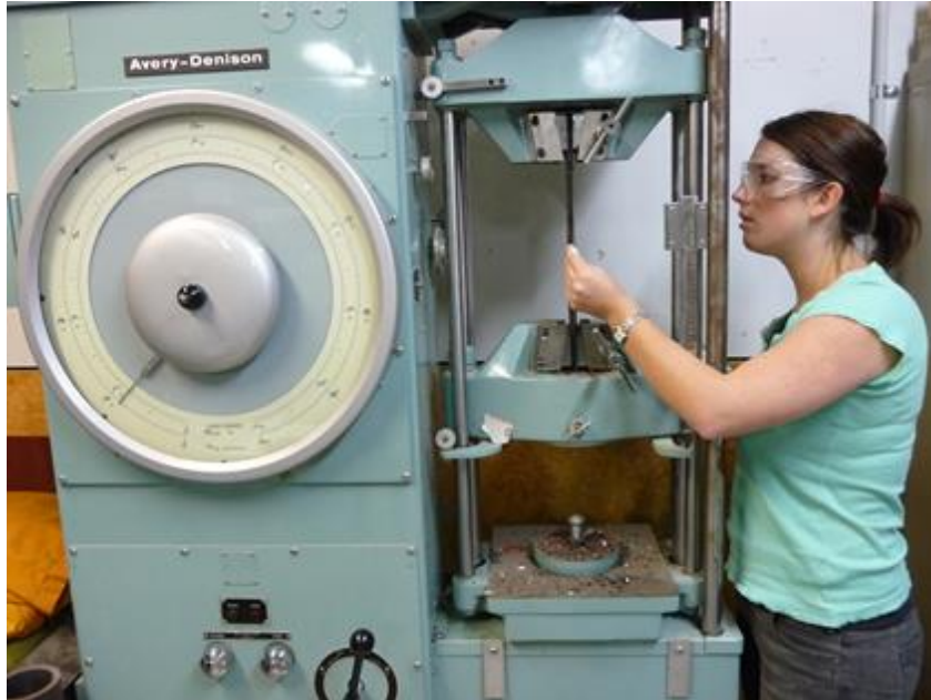
तस्वीर 1. स्टील की एक छड़ की जाँच हो रही है। ये देखना ज़रूरी है कि निर्माण सामग्री मानकों के अनुरूप है।
