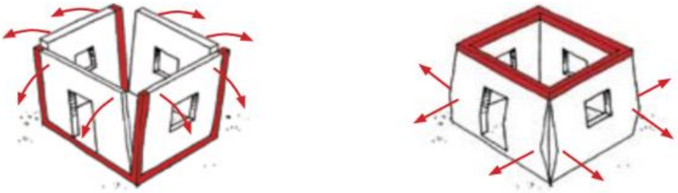
तस्वीर 3. एक मकान की दीवारों को भूकंप के दौरान गिरने से रोकने के लिए सिर्फ स्तम्भ काफी नहीं होते, बल्कि तल एवं छत के स्तर पर टाई बीम की भी जरूरत होती है (From Guide book for building earthquake resistant houses in confined masonry; World Housing Encyclopedia, 2018)।
