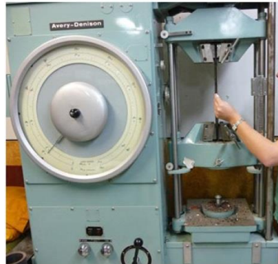
شکل ۱. آزمایش میلگرد تقویتی برای بررسی تطابق آن با استاندارد.
