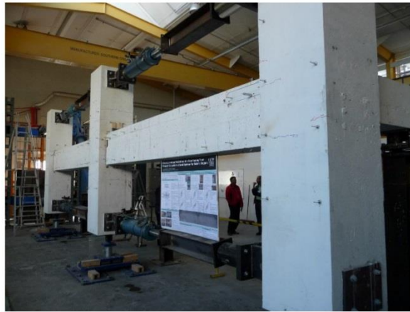
شکل ۱. ستون‌ها و تیرهای بتن مسلح تمام مقیاس تحت بررسی‌های آزمایشگاهی.
