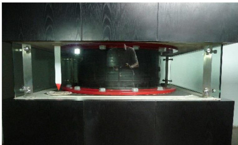
شکل ۴. یک جداساز لاستیکی دایره‌ای حاوی صفحات فولادی بسیار نازک که بین انتهای پایینی ستون‌ها و پی‌ها به منظور جداسازی ساختمان از لرزش افقی زلزله قرار داده می‌شود.
