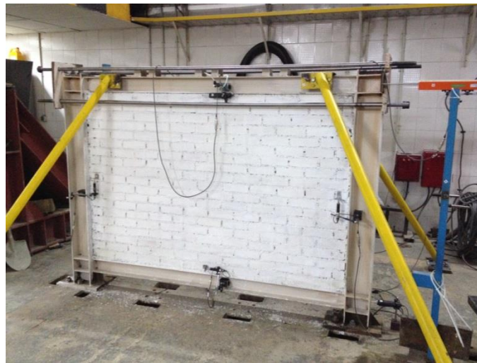
شکل ۲. دیوار بنایی تحت بررسی آزمایشگاهی در آزمایشگاه پژوهشگاه بین‌المللی زلزله‌شناسی و مهندسی زلزله.
