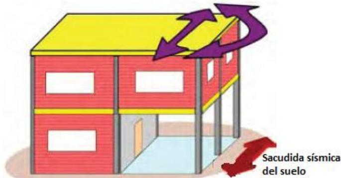
Figura 11. Un edificio con una abertura en la primera planta de un lado gira durante una sacudida sísmica (fuente: Murty 2005).
