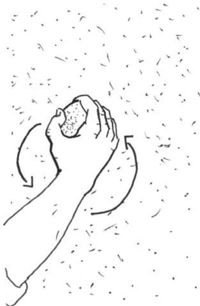
**Recuerda que** el pulido con piedra contribuye a incrementar la resistencia del tarrajeo a la lluvia pues pule el acabado de la superficie.
