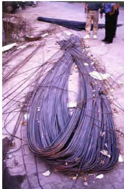
**Gambar 55.** Baja tulangan polos yang dikirim ke sebuah lokasi konstruksi di Turki, ditekuk hingga berbentuk "U" (sumber: Gulkan et al. 2002).
