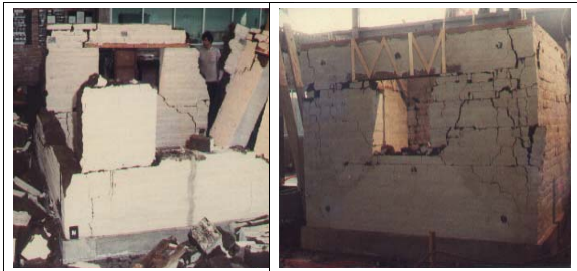
Figura 18 – Comportamiento Sísmico de un Módulo de Adobe sin Refuerzo (Izquierda) y de un Módulo de adobe con Refuerzo Interior de Caña y Viga Collar (Derecha) (Blondet y otros, 2002)
