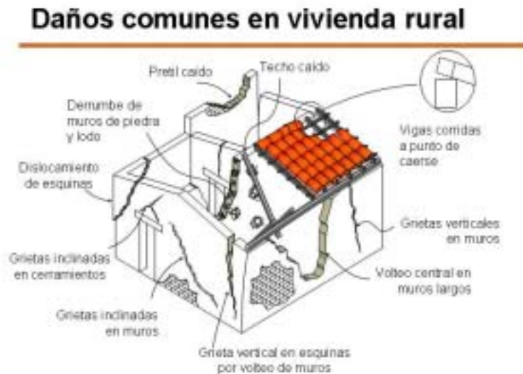
Figura 4 – Deficiencias Sísmicas de Albañilería de Adobe (CENAPRED)
