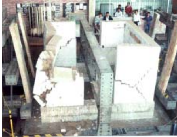
Figura 20 – Ensayo Dinámico de Muros en Forma de “U” (Zegarra y otros, 1997)
